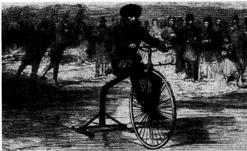
Das Vorderrad dieses Vehikels, das erstmals 1868 auf der Newski fuhr, trägt Metallspikes, statt des Hinterrads sind Leitkufen angebracht
